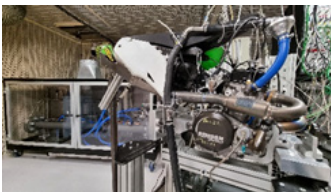
Essais du moteur H2 au banc AKIRA H2 piston engine test at the AKIRA testing bench
